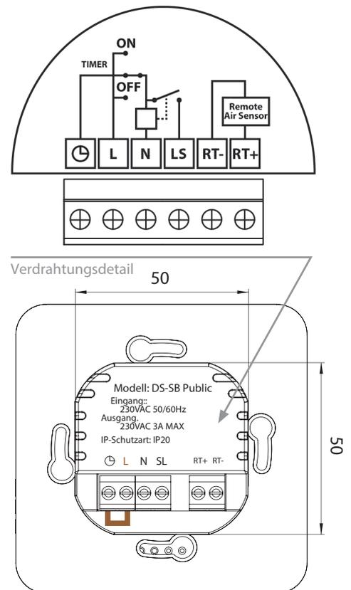
**\*Für Rückstellmodus, die Verbindung zwischen und L entfernen ⊕**
