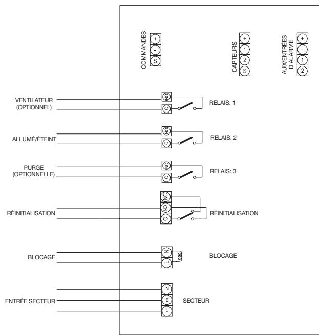
Le câble blindé double Beldon 8451 doit être utilisé pour la connexion du capteur à distance et des câbles de commandes. RS pièce n° : 360-649
