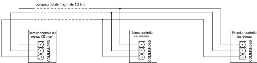
Le câble blindé double Beldon 8451 doit être utilisé pour la connexion du capteur à distance et des câbles de commandes. RS pièce n° : 360-649
