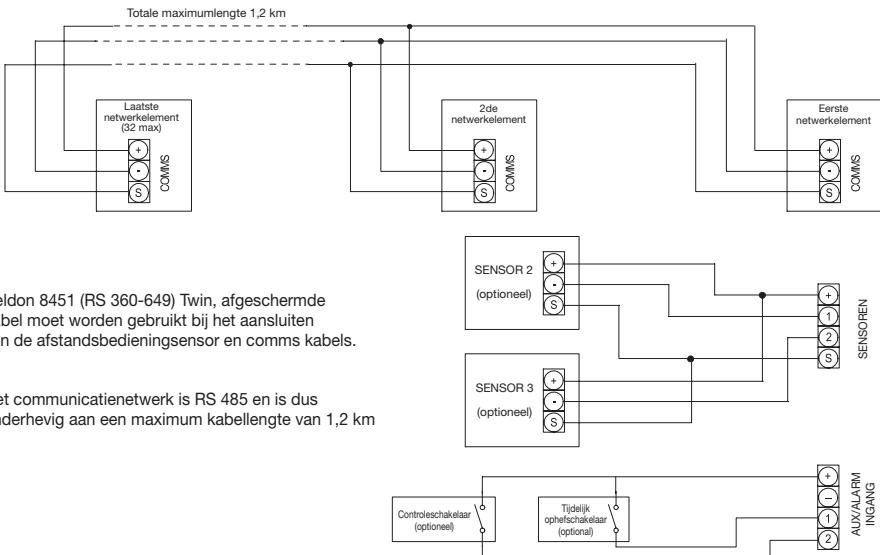
Beldon 8451 (RS 360-649) Twin, afgeschermde kabel moet worden gebruikt bij het aansluiten van de afstandsbedieningsensor en comms kabels.
