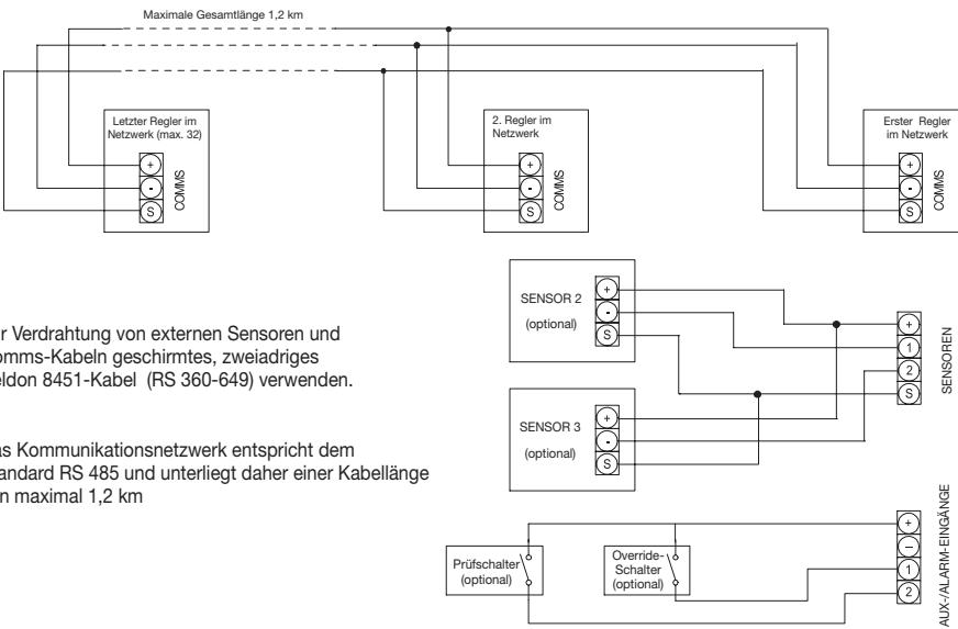
Zur Verdrahtung von externen Sensoren und Comms-Kabeln geschirmtes, zweiadiges Belden 8451-Kabel (RS 360-649) verwenden.
